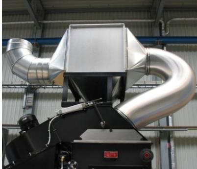
Kreuzstromwärmetauscher zur Wärmerückgewinnung aus Trocknerabluft.
